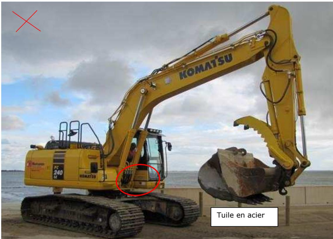
Figure 44 : Vue d'une pelle avec tuile acier.
